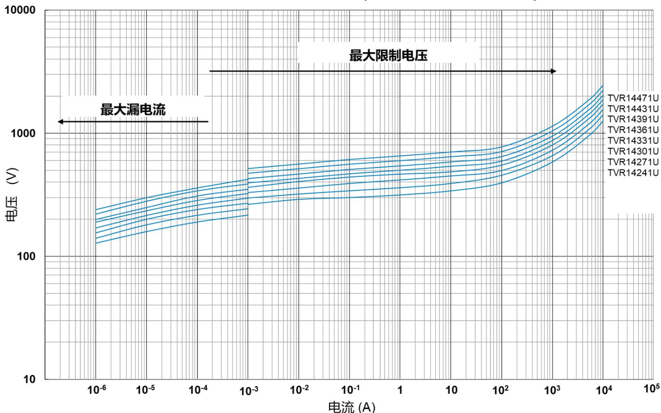
最大漏电流与最大限制电压曲线 (TVR14511U~TVR14112U)
